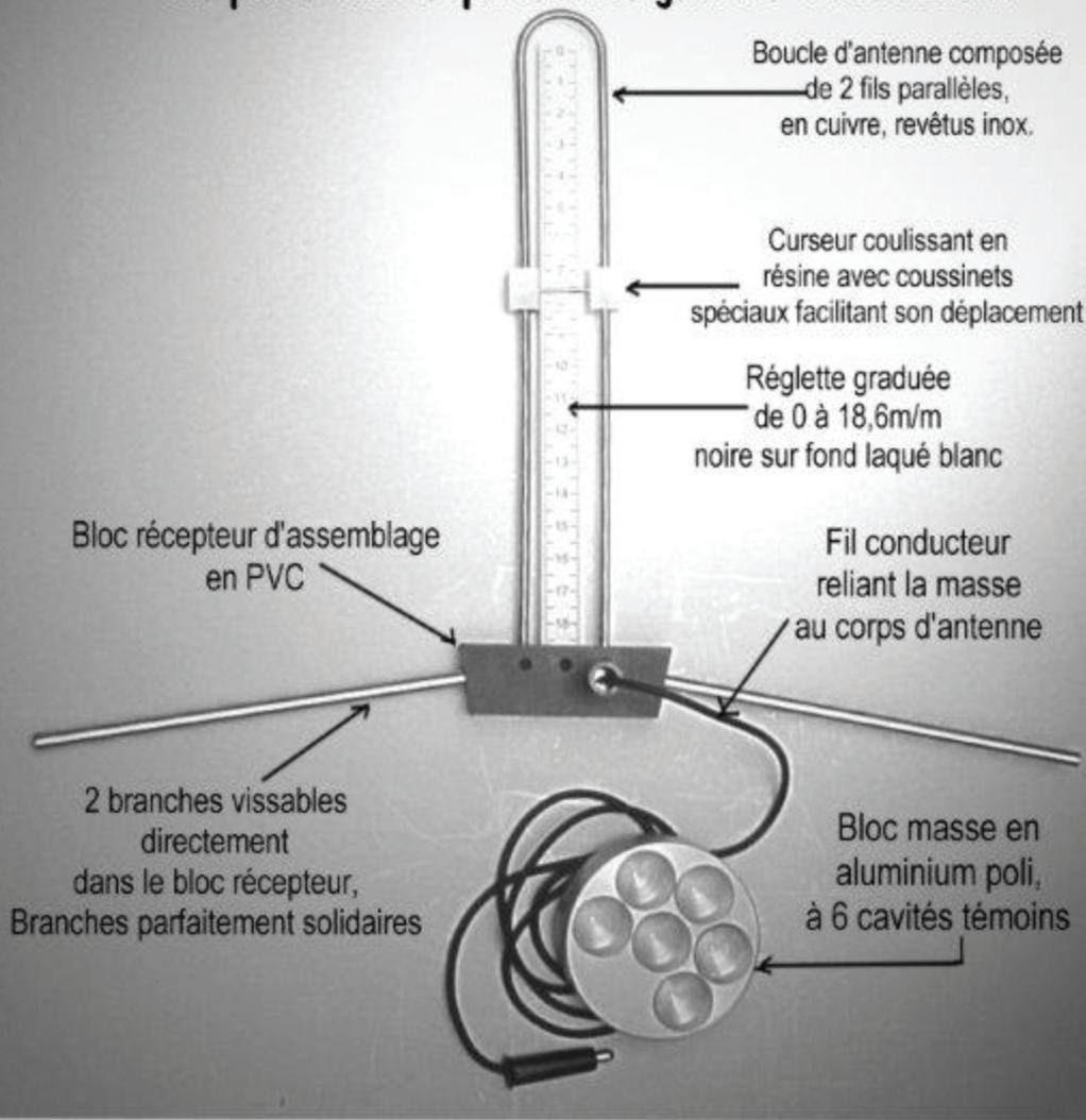
Boucle d'antenne composée de 2 fils parallèles, en cuivre, revêtus inox.
